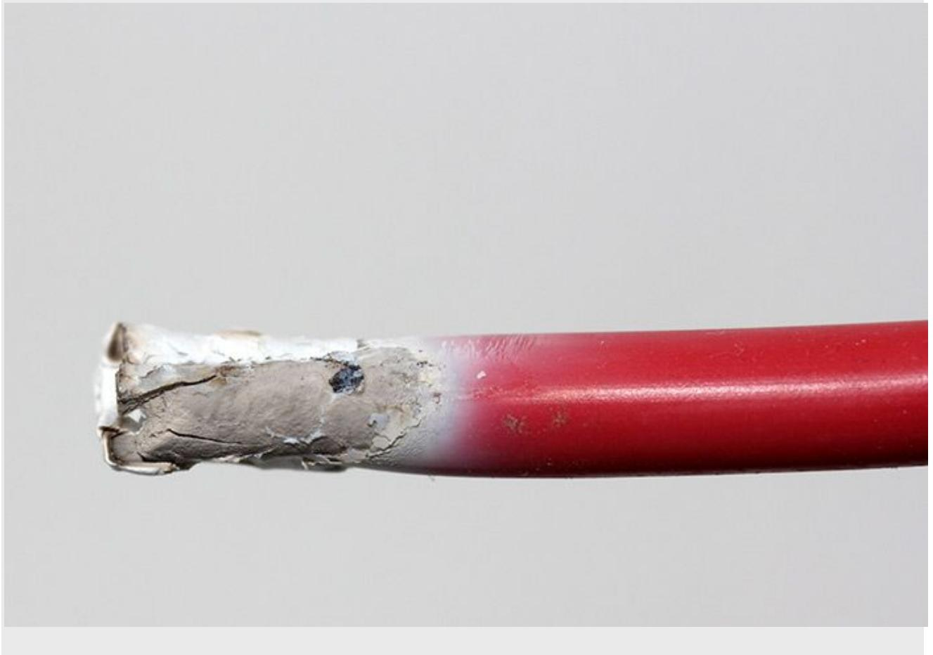
**Керамическое покрытие, образующееся при воздействии огня обладает высокими изоляционными и механическими характеристиками и отвечает требованиям международных стандартов NFC 32070CR1, BS 6387 class Z, EN 50200.**
